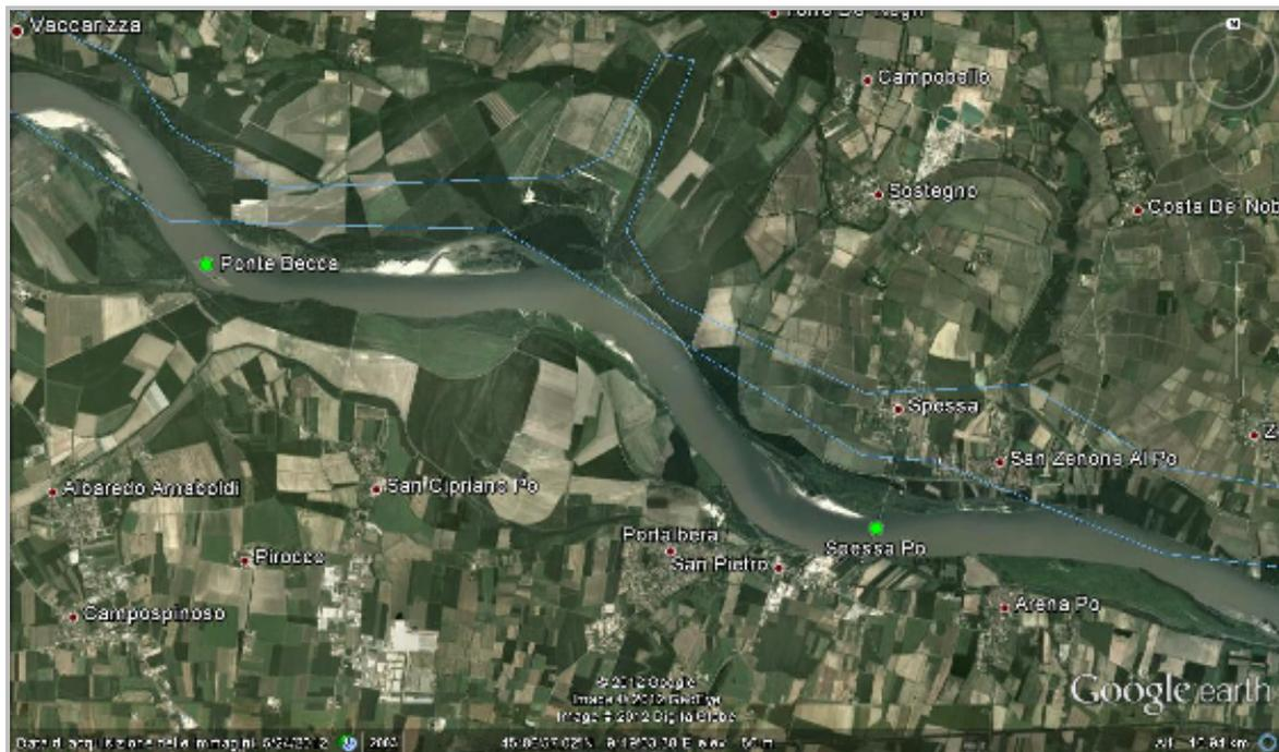
**Figura 8 Stazioni idrometriche mappate con il pallino verde, dei comuni interessati al piano di emergenza**
