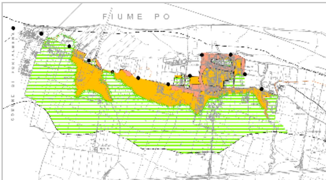
**Figura 4** Particolare di Arena Po estratto dalla carta di valutazione del rischio del PGT vigente (si distinguono le aree campite in rosa dove le acque della piena supererebbero il metro di altezza R4; in giallo le aree dove le acque non raggiungerebbero il metro di altezza R2; in verde sono le aree all'interno del PAI che non si allagherebbero R1 secondo il DGR. 7/7365)
